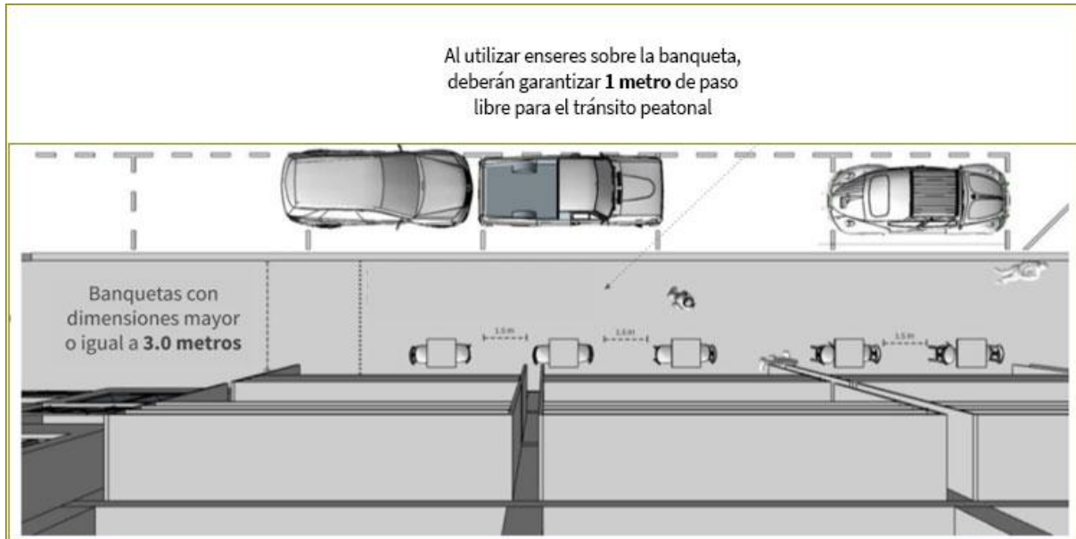
Figura 5. Colocación de enseres en banquetas con un ancho igual o mayor a 3.0 metros
